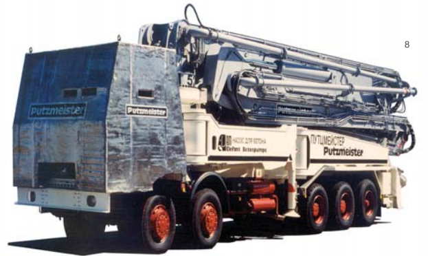
Radyasyona karşı koruma: Chernobyl' de kullanılan Putzmeister beton pompaları kurşunla kaplandı.
