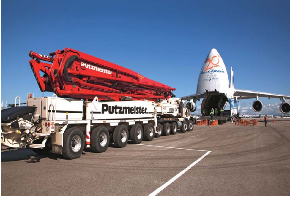
Dünyanın en büyük buma sahip mobil beton pompası Putzmeister M70, Japonya - Fukushima'ya gönderilirken.
