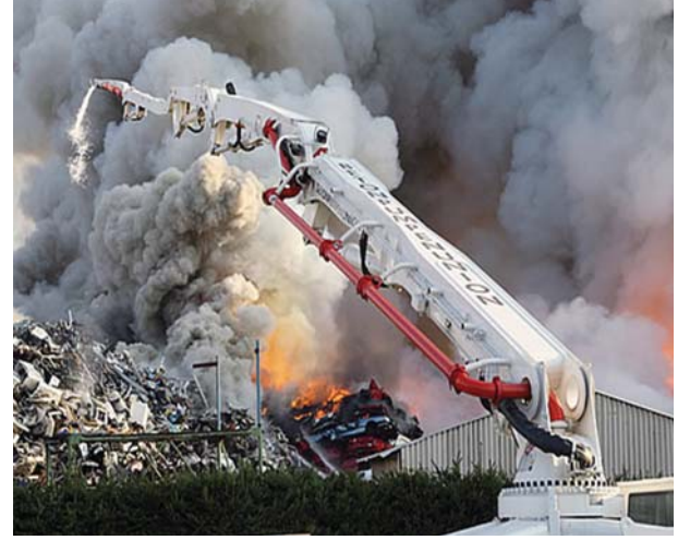
Putzmeister M46-5 kamyonu monte beton pompası. yangın söndürmek için çalışıyor.
