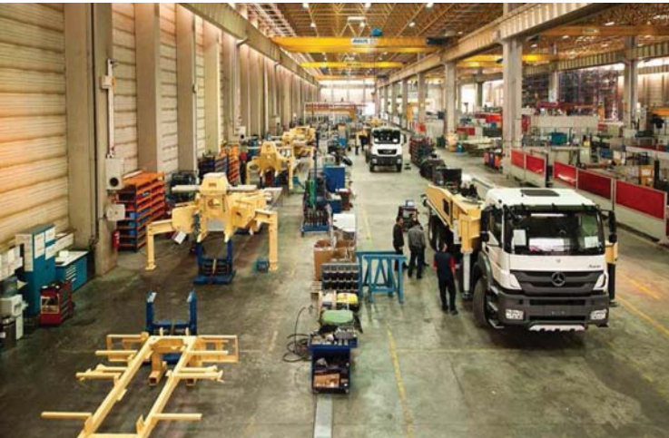
Çerkezköy fabrikamızda, istenen özelliklere sahip her marka kamyonu beton pompası montajı yapılmaktadır.
